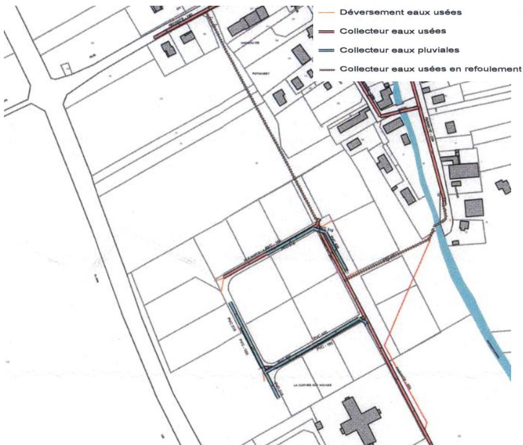
Figure 27 : Schéma du réseau d'assainissement identifié par le PLU
